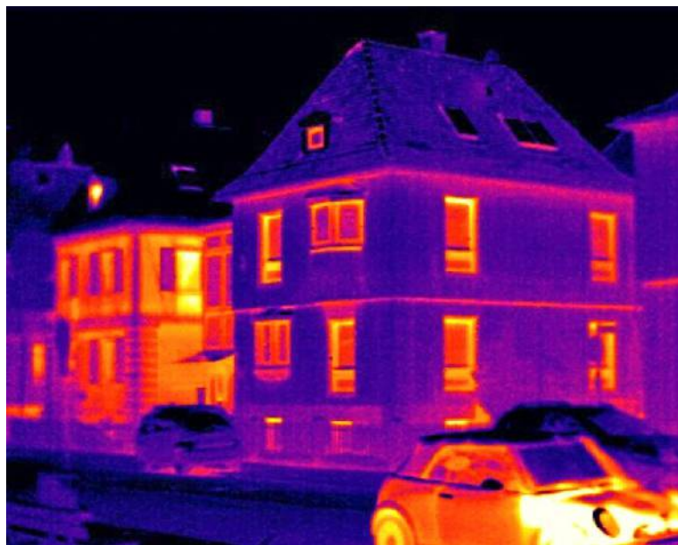
Thermografie-Aufnahme mit ungedämmtem Haus (links) und gedämmtem Haus (rechts) nebeneinander. Der starke Wärmeverlust in roter Farbe ist beim linken Haus deutlich zu erkennen.
